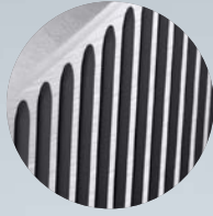
Lasergravieren Oberflächengüte reduziert auf Ra 1,0 µm
