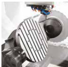
Tavola rotobasculante con motori torque e doppio supporto
