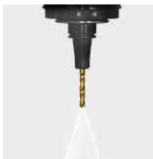
Aria attraverso il mandrino/ refrigerante attraverso il mandrino
