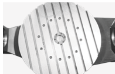
Tavola rotante orientabile con scanalature parallele
