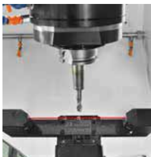
Sistema di misurazione laser degli utensili
