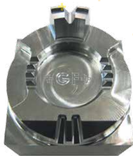
Surface: Ra 0.10 Matière: X45NiCrMo4 (1.2767) Dureté: 54 HRC
