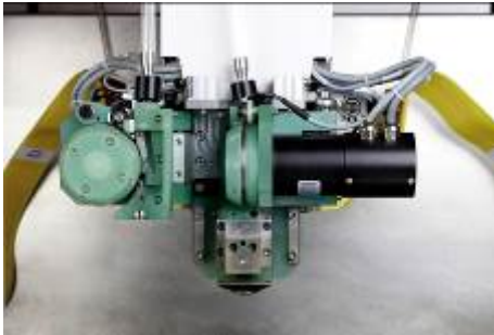
Foto: CUT 2000 S mit AWC (AWC = Automatical Wire Changer)
