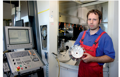
Udo Dietrich mit Werkstück Lüfterrad an einem Hochgeschwindigkeits-Bearbeitungszentrum Mikron HSM 600U ProdMod
