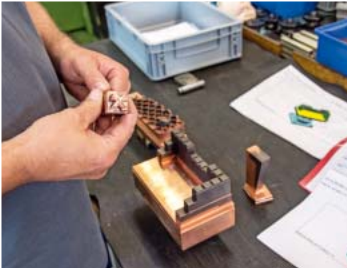
Elektroden mit komplexen Formen für die Senkerosion werden 5-achsig gefräst
