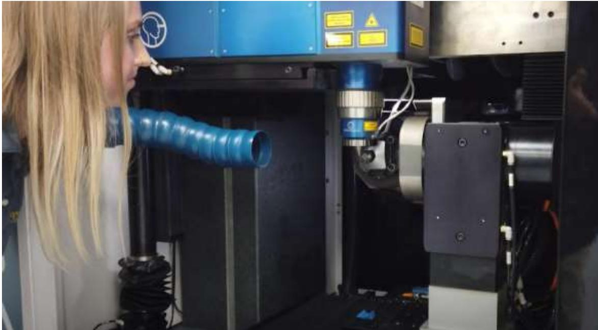
Les lasers femtoseconde à l'intérieur des machines ont des impulsions ultra brèves de l'ordre de quelques centaines de femtosecondes.
