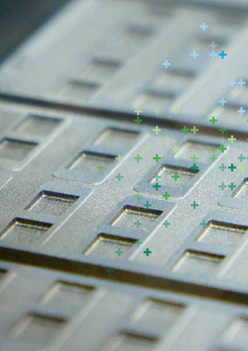
3DS模具表面纹理加工提高注塑效果 GF加工方案的智能高速脉冲电源（ISPG）的全新三维表面纹理加工技术（3DS）带给您更完美的表面纹理。
