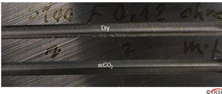
Abbildung 5: Vergleich der Oberflächenqualität von Nuten, die durch Trocken- und scCO_2 -Fräsen hergestellt wurden
