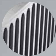
激光雕刻 表面质量达Ra 1.0 μm
