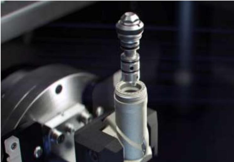
In einer Weltpremiere bietet GF Machining Solutions dem Bediener die Möglichkeit, dank einem schnellen und einfachen System von Wechselkartuschen für die CUT X Reihe mit offenen oder geschlossenen Führungen zu arbeiten.
