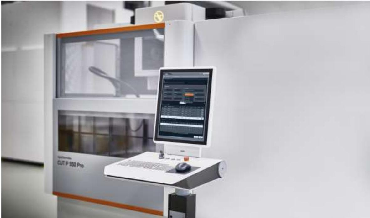
Die neue Mensch-Maschine-Schnittstelle (HMI) Uniqua, hier an der CUT P 550 Pro, bietet eine optimale Funktionalität und Ergonomie für jeden Kenntnisstand.
