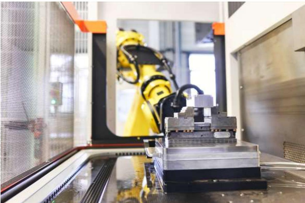
Für mehr Flexibilität und Produktivität kann Dynafix Tooling zwischen Senkerodier-, Fräs- und Lasermaschinen in derselben automatisierten Zelle geteilt werden.
