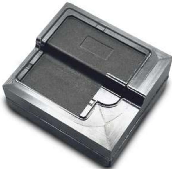
Der Formeinsatz eines Steckers ist ein gutes Beispiel für die Lasertexturierung einer 3-D-Oberfläche mittels 5-Achs-Bearbeitung.
