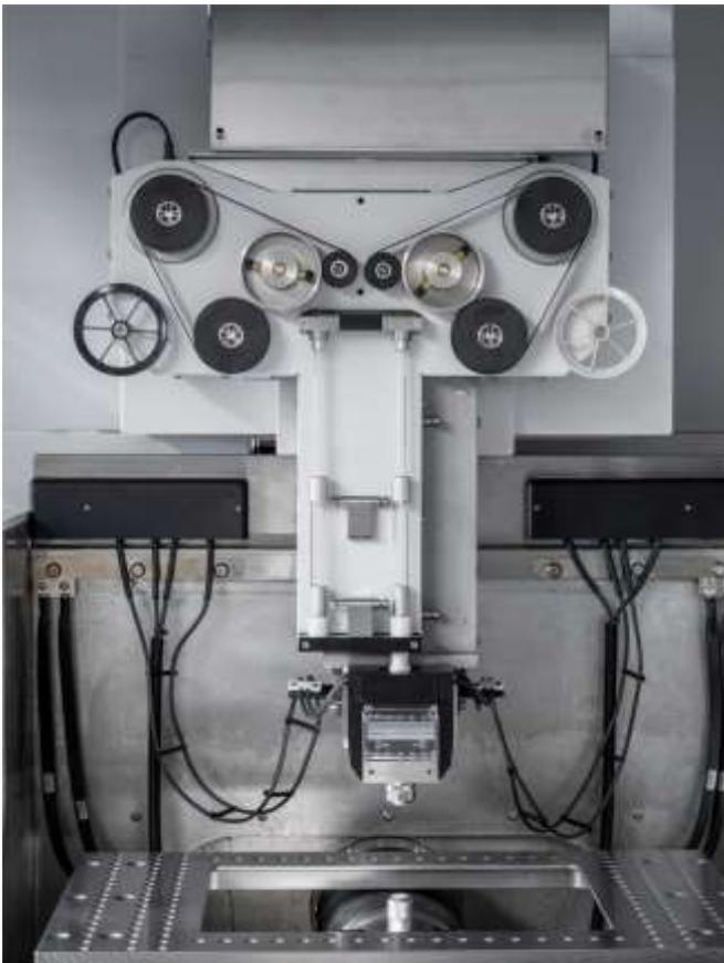
La machine CUT X comprend deux circuits à fil identiques et symétriques pour un dégrossissage et une finition simples et rapides, une vitesse et une précision de coupe optimales et une double autonomie du fil.
