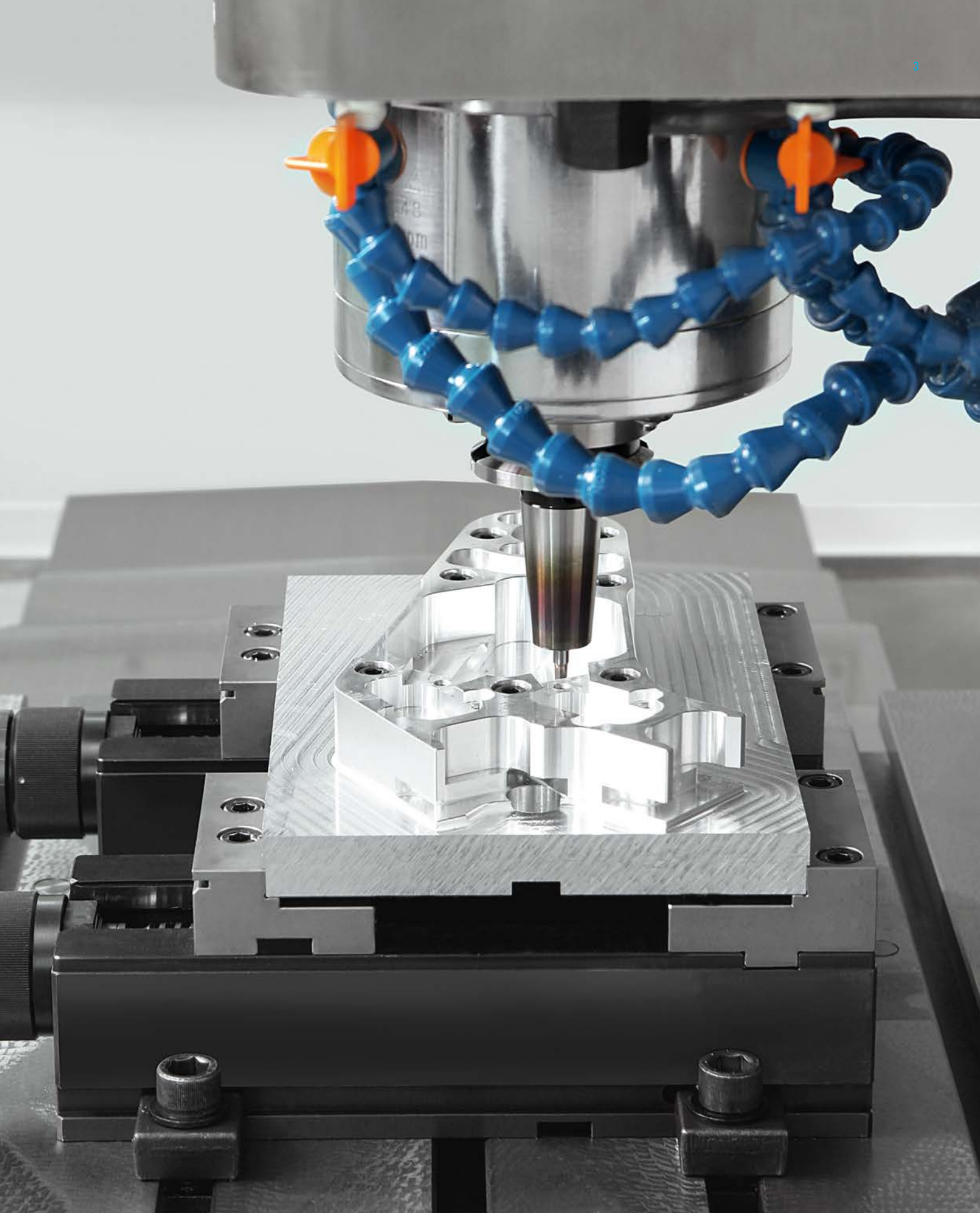
Anwendungsbeispiel: Bearbeitung eines Werkzeuggreifers. In einer Aufspannung aus dem Vollen gefräst.
