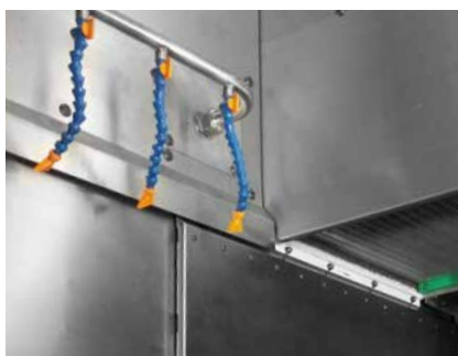
System sputkiwania wiórów
