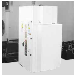
Werkzeugmagazin HSK-A/T63: 120 Werkzeuge
