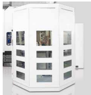
Werkzeugmagazin HSK-A/T100: 170 Werkzeuge HSK-A/T63: 238 Werkzeuge
