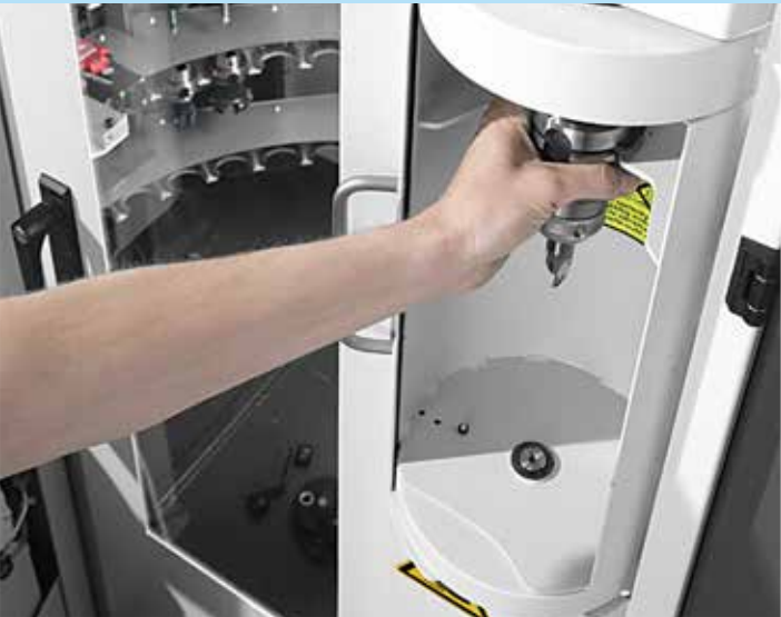
120、170或215刀位 带刀具运送系统的环形刀塔
