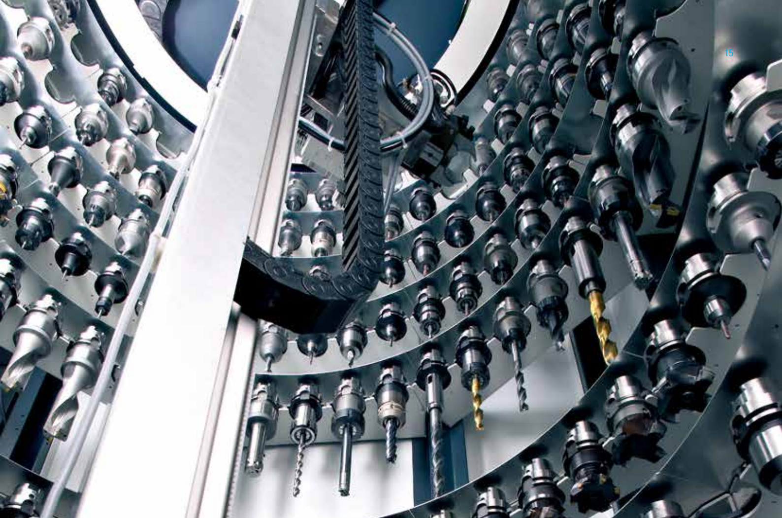
120、170或215刀位 带刀具运送系统的环形刀塔
