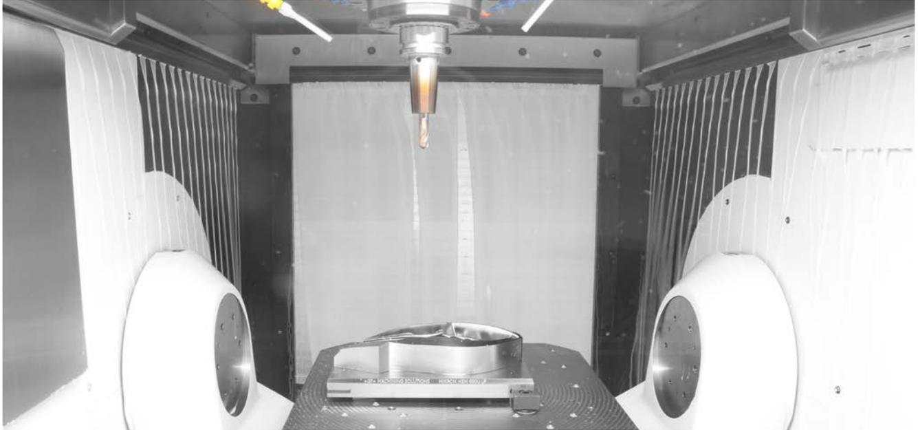
Perfekter Spänefall dank steilen, glatten Kabinenwänden.
