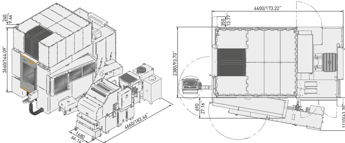
**Mikron MILL P 800 U ST, 120–215 Werkzeuge, Palettenmagazin mit 7–9 Paletten**
