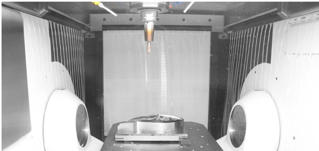
Evacuazione ottimale dei trucioli grazie alle pareti inclinate e lisce della cabina. Prevenzione dell'accumulo di trucioli grazie ai getti di lavaggio.
