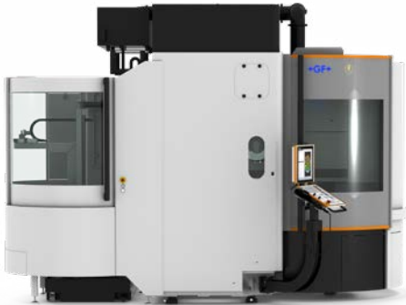
Almacén de pallets
